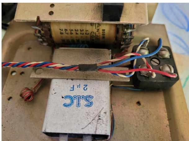
On déconnecte tous les câbles de ce bornier, y compris ceux qui sont soudés en-dessous et on supprime le bornier pour gagner de la place.
